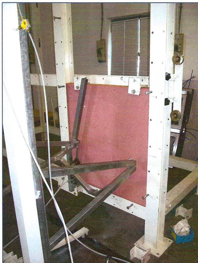
Foto del campione dopo l'impatto con altezza di caduta pari a 1200 mm LATO ESTERNO
